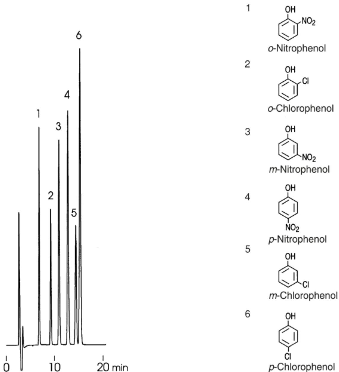
Column : J'sphere ODS-H80 (4  $\mu$ m, 8nm)
