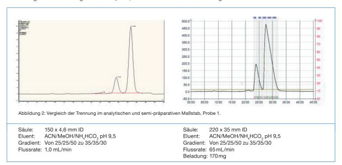
Die Ergebnisse in Abbildung 2 bestätigen, dass die Methode einfach vom analytischen in den semi-präparativen Maßstab übertragen werden kann. Aufgrund der gleichen Packqualität der gepackten Glassäule, kann eine gleichbleibende Trennung bei einer Beladung von 170 mg und einer Flussrate von 65 mL/min erreicht werden.
