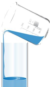
3. Ist das Material vollständig eingefüllt, den Glasrand mit Packlösungsmittel spülen, um Partikelrückstände zu entfernen.
